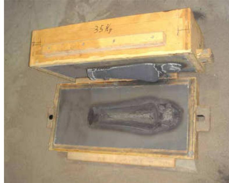
Entnahme des Gusses aus der Sandform
