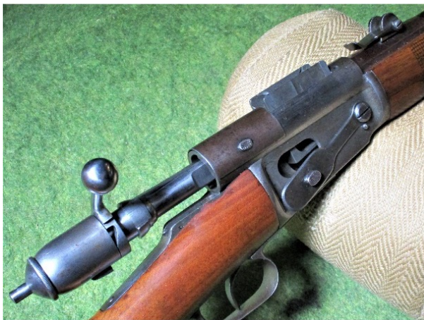
Abbildung 9: Vetterligewehr mit offenem Verschluss
