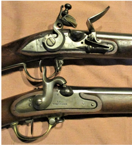
Abbildung 5: Steinschloss (oben); Steinschloss auf Perkussion umgeändert (unten)
